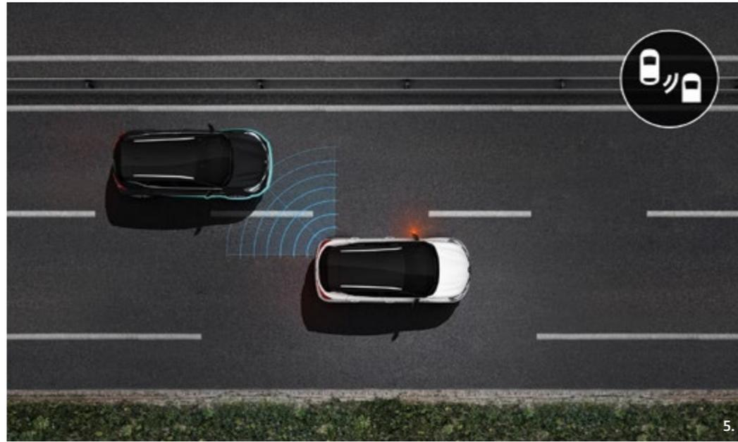
**5. Toter-Winkel-Warner.** Der neue Captur macht das Abbiegen sicherer, denn er warnt Sie mit einem Leuchtsignal im Außenspiegel, wenn ein anderes Fahrzeug im toten Winkel auftaucht.
