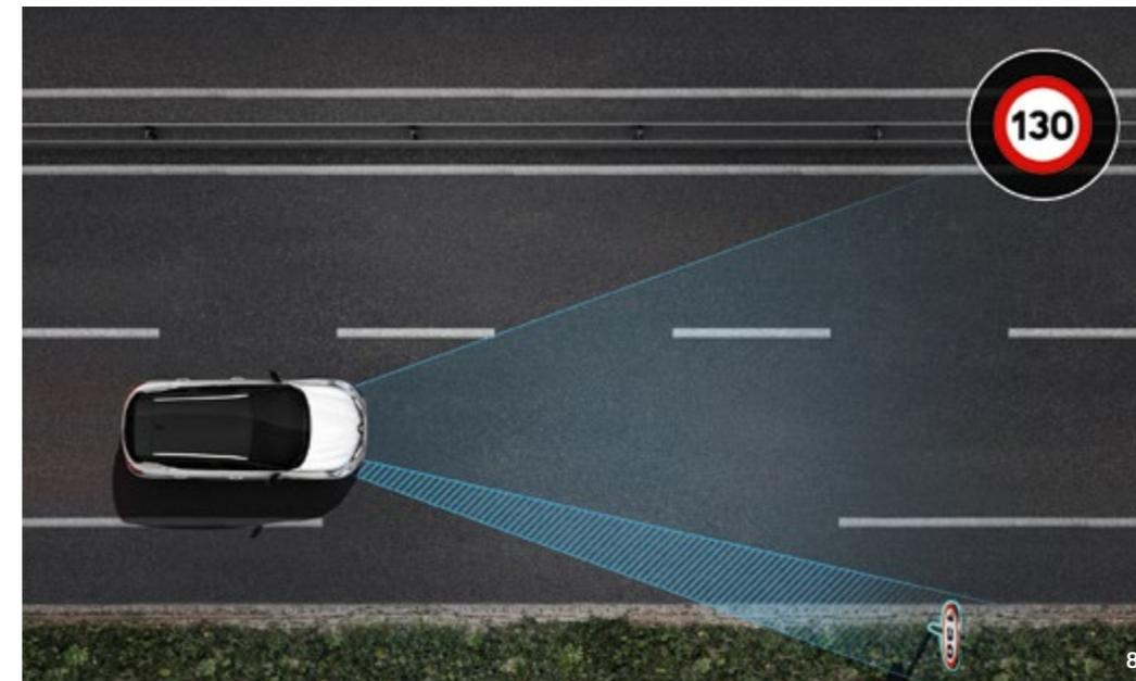
**8. Geschwindigkeitswarner mit Verkehrszeichenerkennung.** Die Kamera des neuen Renault Captur erkennt Verkehrsschilder und die geltenden Geschwindigkeitsbeschränkungen und das System weist Sie darauf hin, wenn Sie die zulässige Höchstgeschwindigkeit überschreiten.
